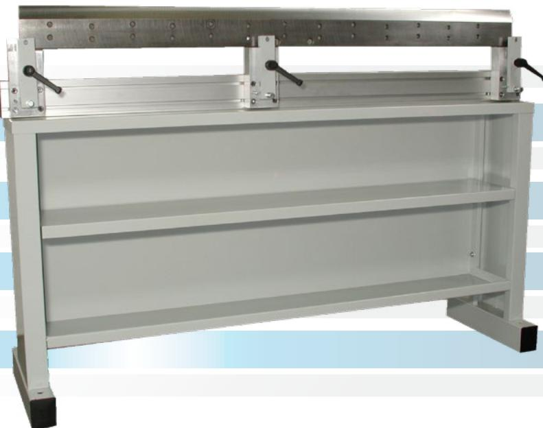
■ Banco d'appoggio e fissaggio per lame lineari, costituito da una base di sostegno, un ripiano per l'alloggio di lame ed utensili, tre morse che consentono una linearità ottimale per la corretta esecuzione della sbavatura manuale delle lame.
