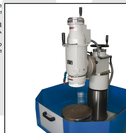
Colonna regolabile con corsa fino a 310 mm
