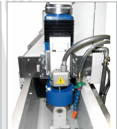
Testa di superfinitura 1,1 kW
